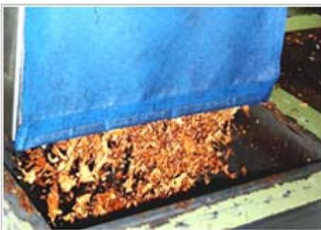
Depois que o tabaco foi suficientemente umedecido, ele é colocado em uma caixa medindo mais ou menos 40 x 40 cm e cerca de 1 metro de profundidade. Então um pistão lentamente pressiona o tabaco pra formar um bloco medindo 40 x 40 cm e cerca de 3 cm de espessura. O bloco é colocado sobre outros blocos e é importante que eles sejam mantidos sob pressão até que blocos suficientes tenham sido produzidos para encher a prensa de tabaco.
